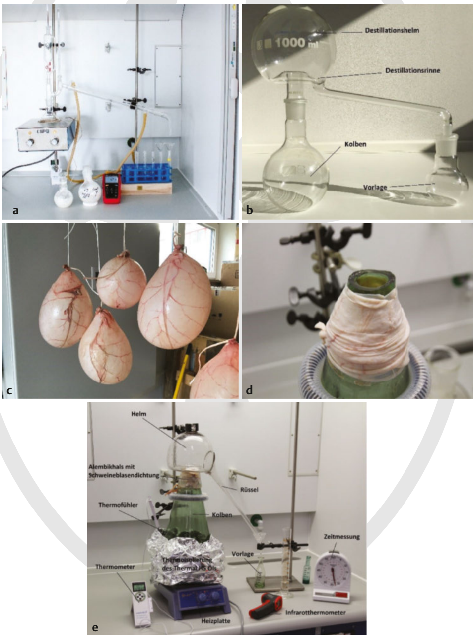
► Abb. 1 Stufenweiser Versuchsaufbau von modern zu historisch; a Moderne Destille; b Schematischer Aufbau der historischen Destille; c Trocknung von luftgefüllten Schweineblasen; d Schweineblasendichtung auf historischem Kolben; e Aufbau mit Kolben und Helm aus Hahnemanns Zeit.
